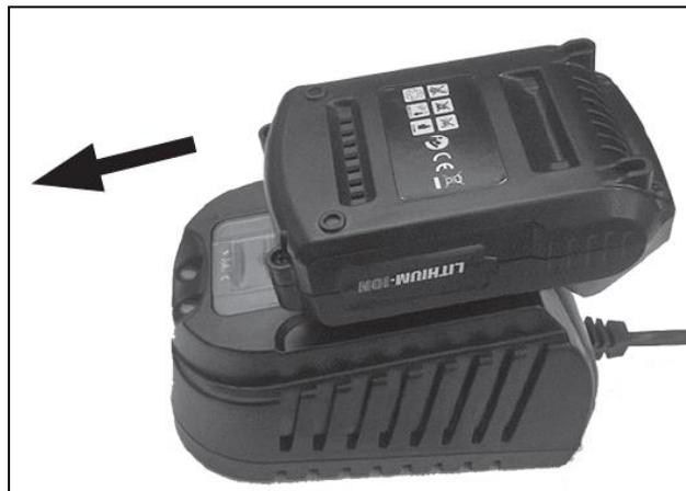
Si aucun témoin ne s'allume, cela signifie que la batterie n'est pas correctement insérée dans le chargeur.
